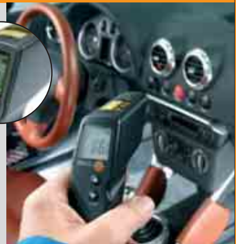
Temperaturkontrolle an einer Lüftung
