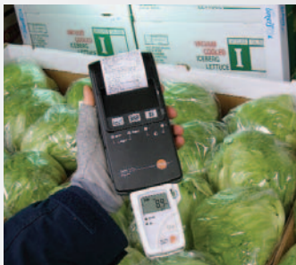
Dokumentation mit hoher Geschwindigkeit und Logger-Neustart mit testo 575
