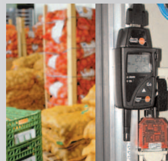
Auslesen der im Logger gespeicherten Messdaten über das PC-Netzwerk mit dem Ethernet-Adapter
