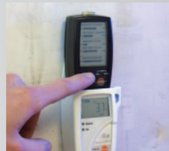
Mit testo 580 Daten vor Ort einsammeln, am PC zentral auslesen und auswerten
