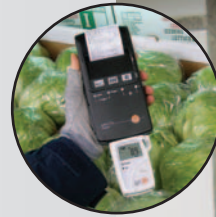
testo 177-T2 mit Display, Daten werden mit dem Schnelldrucker testo 575 dokumentiert
