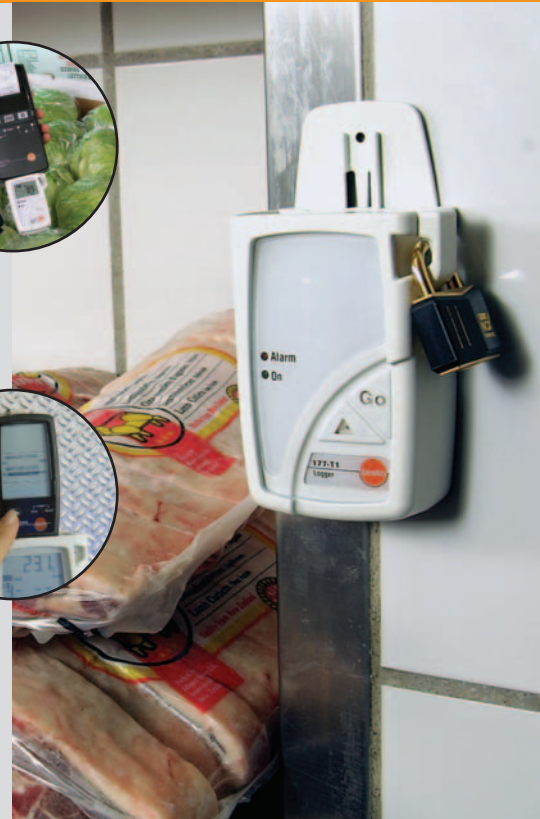
Langzeit-Temperaufzeichnung in einem Zwischenlager mit testo 177-T1 (ohne Anzeige)
