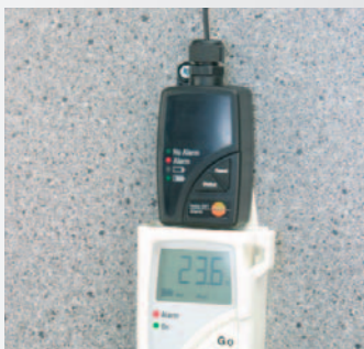
Alarm-Schaltausgang für die zuverlässige Weiterleitung von Grenzwertüberschreitungen
